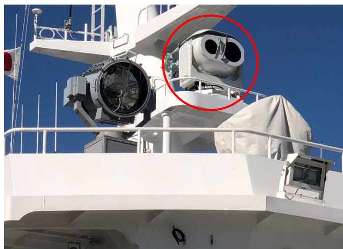
図 1. 船舶搭載用カメラスタビライザ ACE-SX1
