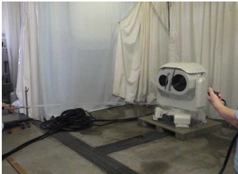
図 6. 防水試験風景
