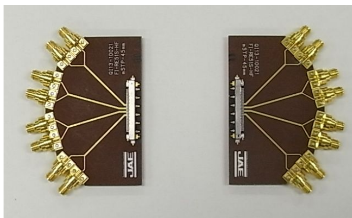
図 3. 測定治具基板
