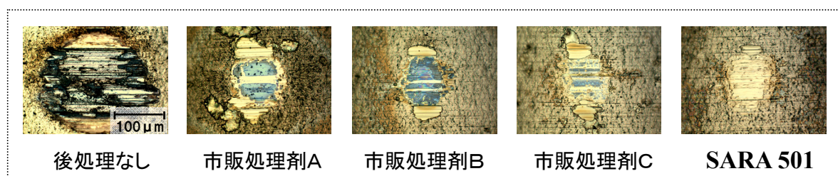
写真3 摺動10,000回後の摩耗痕(Rider)
