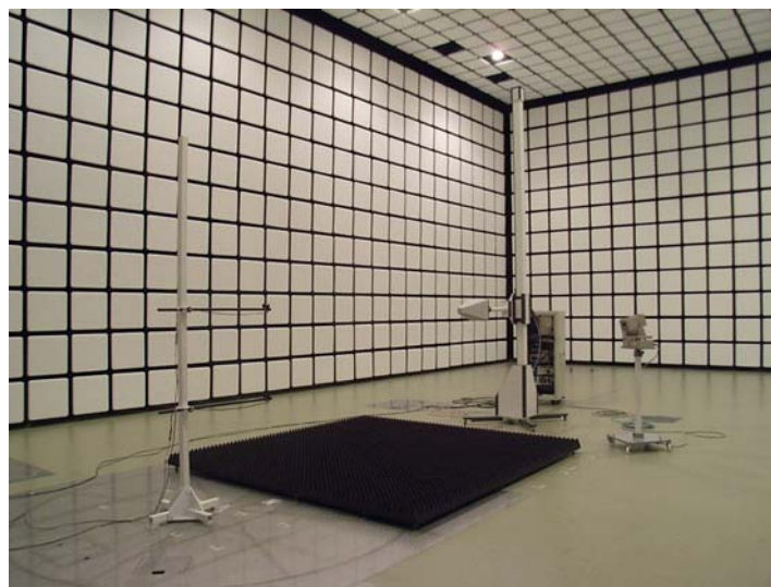
写真11 民生／産業機器の放射性ノイズのEMS評価
