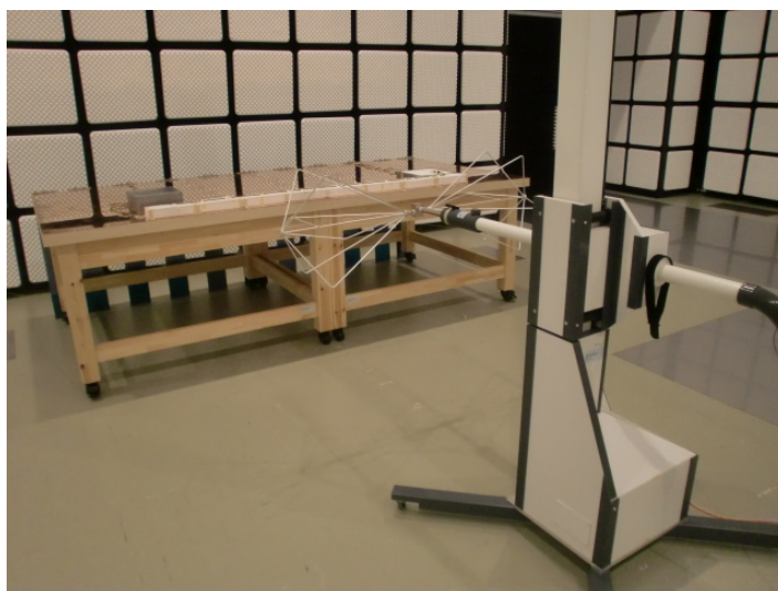
写真12 自動車搭載機器の放射性ノイズのEMI測定
