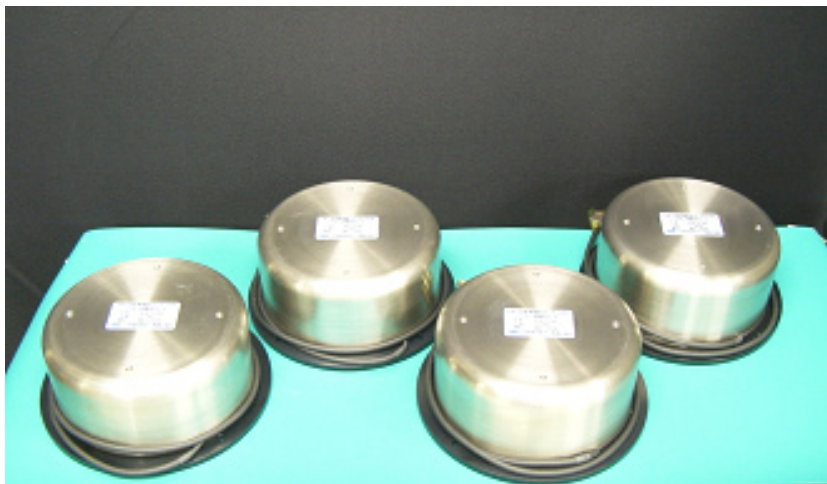
図 4 試作 FOG の外観
