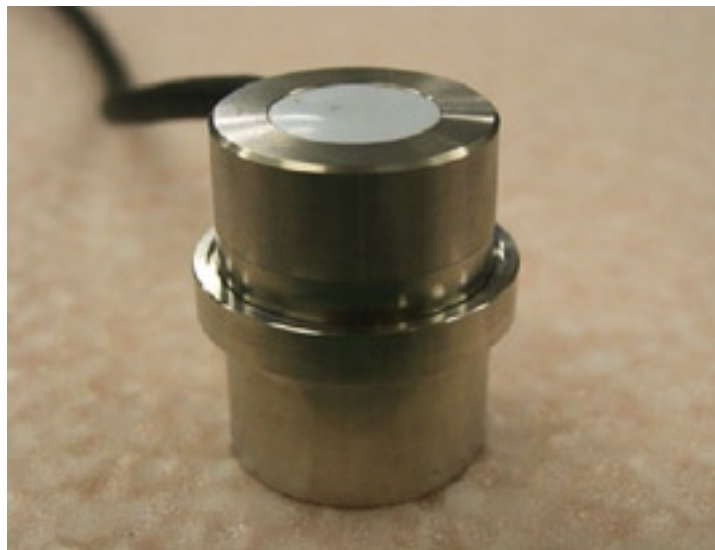
写真 1 JA-40GA 加速度計外観
