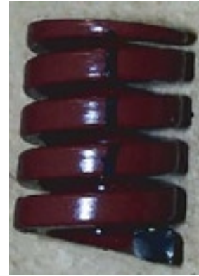
写真 1 コイルバネ破損の例
