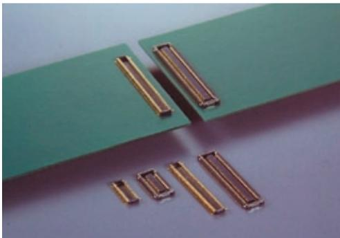
特長；・高密度実装に最適な、耐衝撃・耐落下・耐振動に対応する 0.4mm ピッチ、スタッキングタイプの基板対基板 (FPC) 接続用コネクタ
