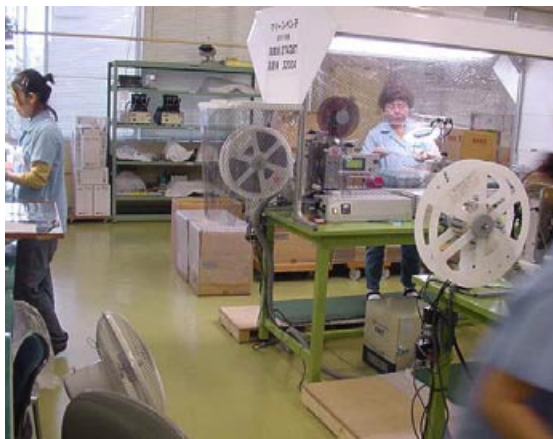
写真6 エンボステープ収納工程
