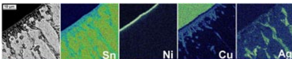
写真 10 Sn-Cu めっきA・Cu 共析率 1.8wt% の初期断面の面分析結果
