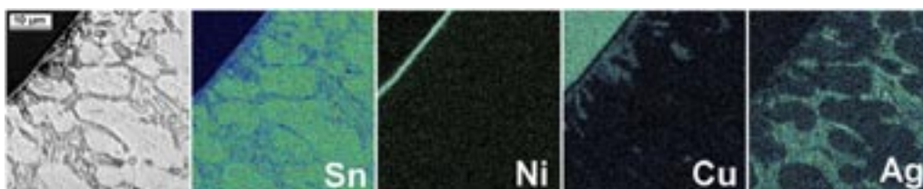
写真 9 Sn-Cu めっきA・Cu 共析率 0.3wt% の初期断面の面分析結果
