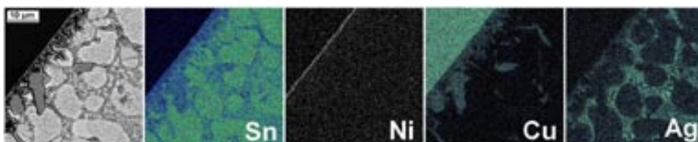
写真 11 Sn-Cu めっきA・Cu 共析率 4.5wt% の初期断面の面分析結果
