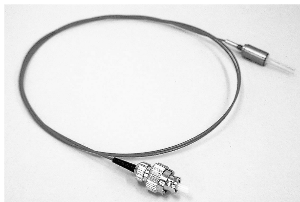
写真3 LDモジュール (F01型光コネクタ使用)
